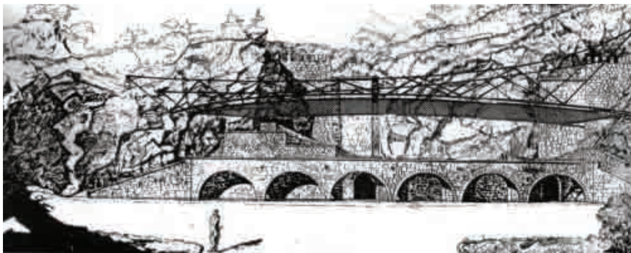
Sl. 16 – Primer otvorene pozornice bez (može i sa) galerije sa kablovskom rešetkom o koju je sa donje strane obešena laka prekrivka. Pokrivka može biti platno, plastika i sl.
